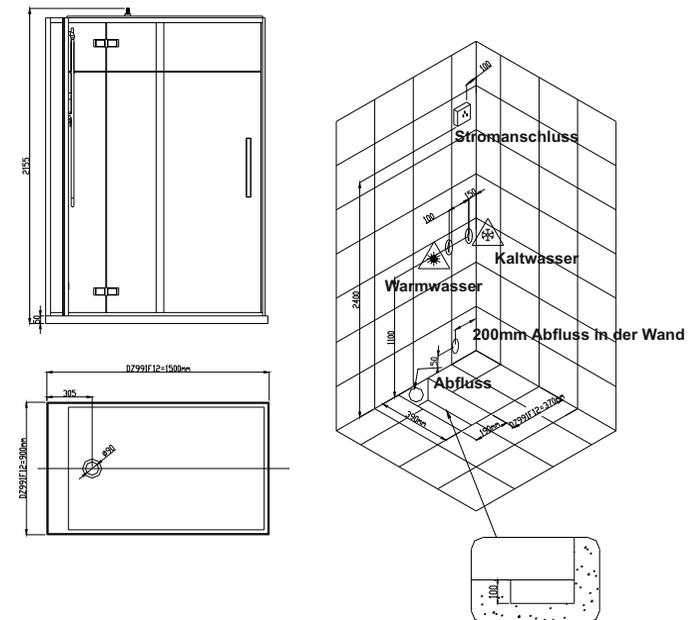
Hinweis: Der Wasserabfluss im Boden muss vor der Installation vorbereitet sein
