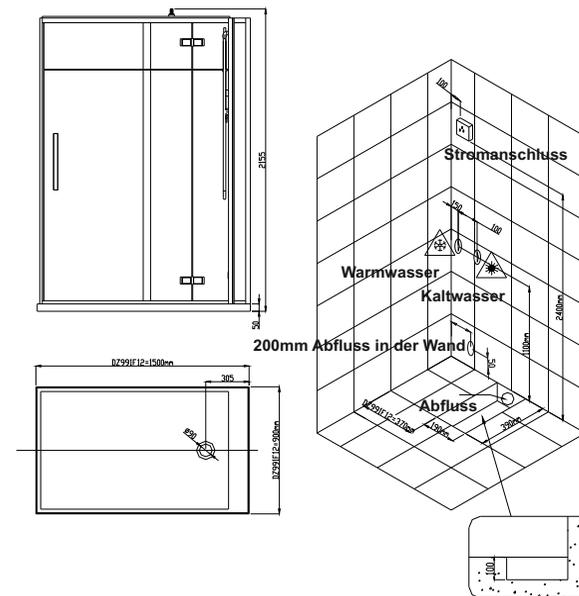
Hinweis: Der Wasserabfluss im Boden muss vor der Installation vorbereitet sein
